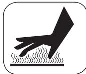
Прикреплена рядом с выхлопной трубой и горячими частями двигателя.
