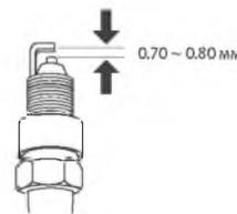
При установке новой свечи зажигания необходимо повернуть ее еще на полоборота после посадки буртика свечи на уплотнительную шайбу, для того чтобы обеспечить требуемую затяжку и уплотнение. При установке старой свечи поверните ее от 1/8 до 1/4 оборота после посадки буртика свечи на уплотнительную шайбу.
