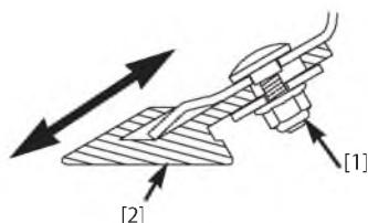
Для обеспечения необходимого зазора повторите данную процедуру. Если вам не удается обеспечить зазор между лопастью и опорной поверхностью величиной 1–3 мм, то следует заменить лезвие скребка.
