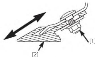
Для обеспечения необходимого зазора повторите данную процедуру. Если вам не удастся обеспечить зазор между лопастью и опорной поверхностью величиной 1–3 мм, то следует заменить лезвие скребка.
