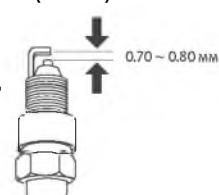
При установке новой свечи зажигания необходимо довернуть ее еще на полоборота после посадки буртика свечи на уплотнительную шайбу, для того чтобы обеспечить требуемую затяжку и уплотнение. При установке старой свечи доверните ее от 1/8 до 1/4 оборота после посадки буртика свечи на уплотнительную шайбу.
