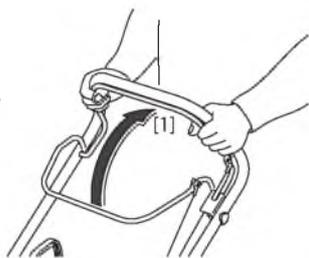
4. С помощью рукоятки руля слегка наклоните вперед снегоуборочную машину [1], чтобы ввести шнек в слой снега. После этого шнек будет перемещать снегоуборочную машину вперед и убирать снег.
