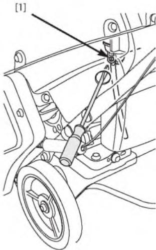
2. Вставьте длинную отвертку с плоским жалом в смотровое отверстие с левой стороны. Сливной винт карбюратора [1] расположен рядом с поплавковой камерой карбюратора. Ослабляйте (не отворачивайте) сливной винт до тех пор, пока не начнется слив топлива. Сливайте топливо до опустошения бака, затем затяните сливной винт.
