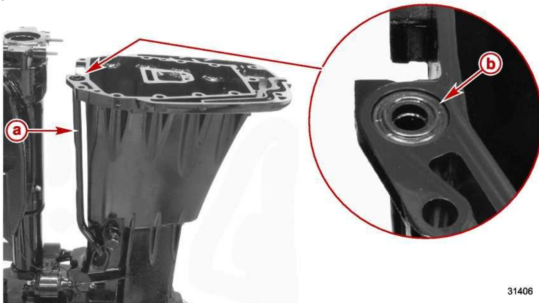
a – Водяная труба b – Верхний сальник
