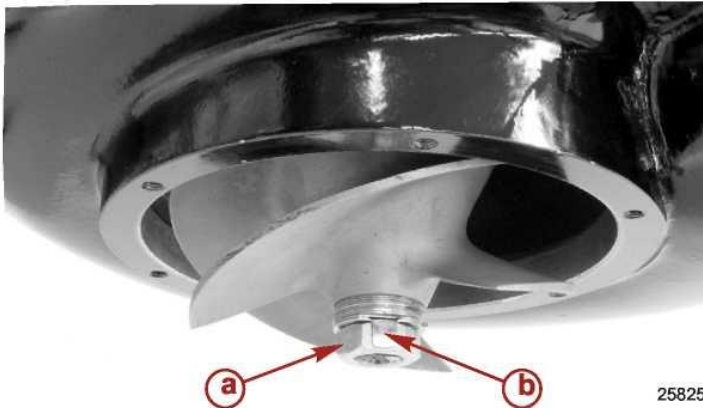
a - Гайка лопастного колеса b - Контровочный выступ
