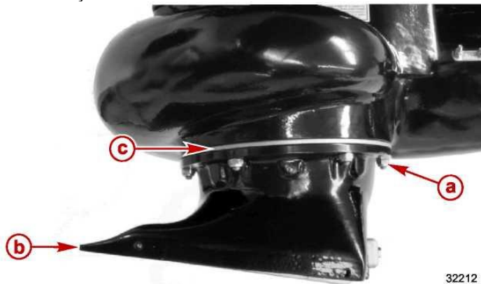
a – Контргайка и шайба (6) b – Передняя сторона кожуха водозаборника c – Гильза / вкладыш
