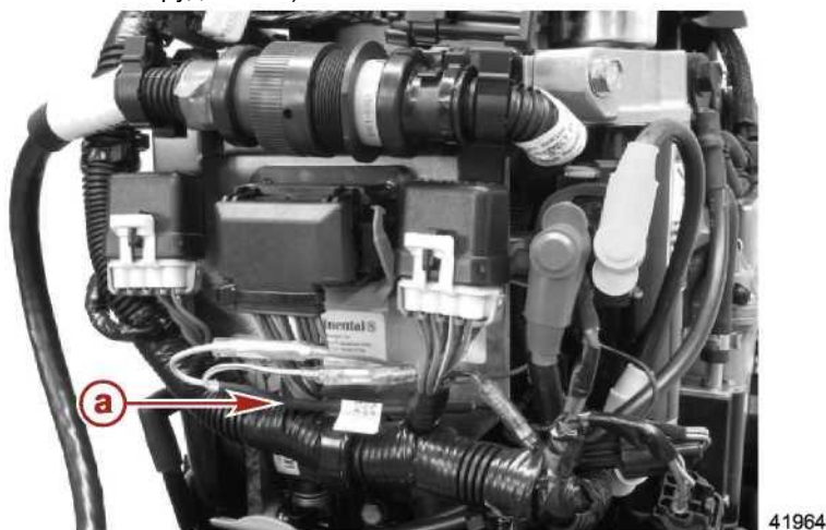
Показана 4-цилиндровая модель а – Диод подавления индуктивных помех
