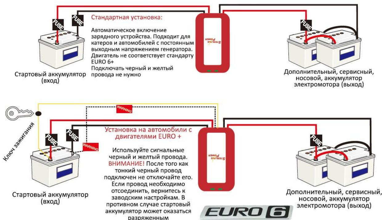
**ВНИМАНИЕ!** Если тонкий черный провод (изображен на рисунке штриховой линией) подключен к отрицательной шине НЕ ОТКЛЮЧАЙТЕ ЕГО – УСТРОЙСТВО МОЖЕТ РАЗРЯДИТЬ СТАРТОВЫЙ АККУМУЛЯТОР. Правильное отключение этого провода описано далее в настоящей инструкции
